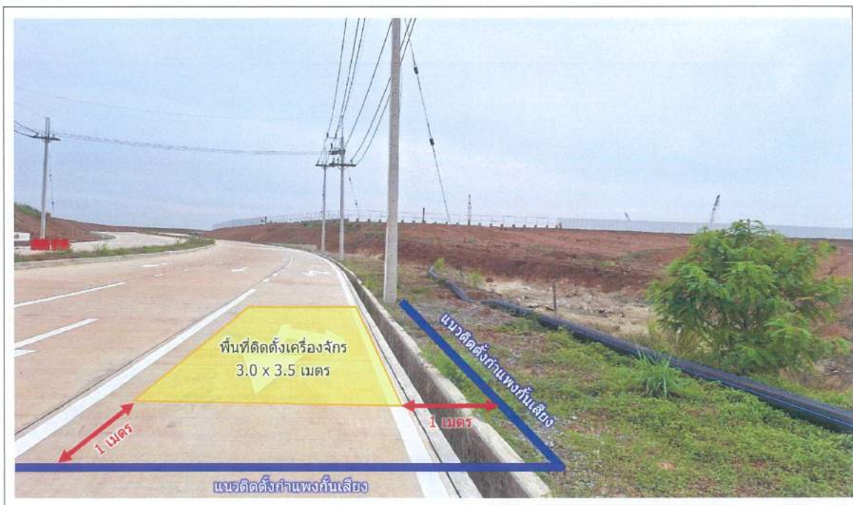
รูปที่ 4.2-13 ตำแหน่งติดตั้งกำแพงกันเสียงบริเวณจุดส่งของการวางท่อด้วยวิธีการเจาะลอด (HDD) ที่อยู่ใกล้เคียงบ้านพักอาศัยริมถนนหลักของนิคมฯ โรจนะหนองใหญ่
